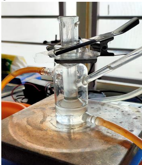
Figure 6.2 : Franz diffusion cell assembly
