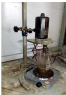
Figure 3. Image du montage de lixiviation
