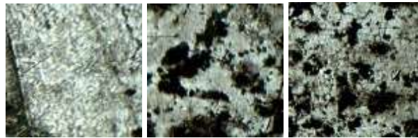
a. Weld zone, b. HAZ, c. Base Metal
