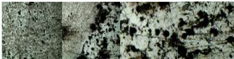
(a) Weld Zone (b) Fusion Boundary (c) Haz (d) Base Metal
